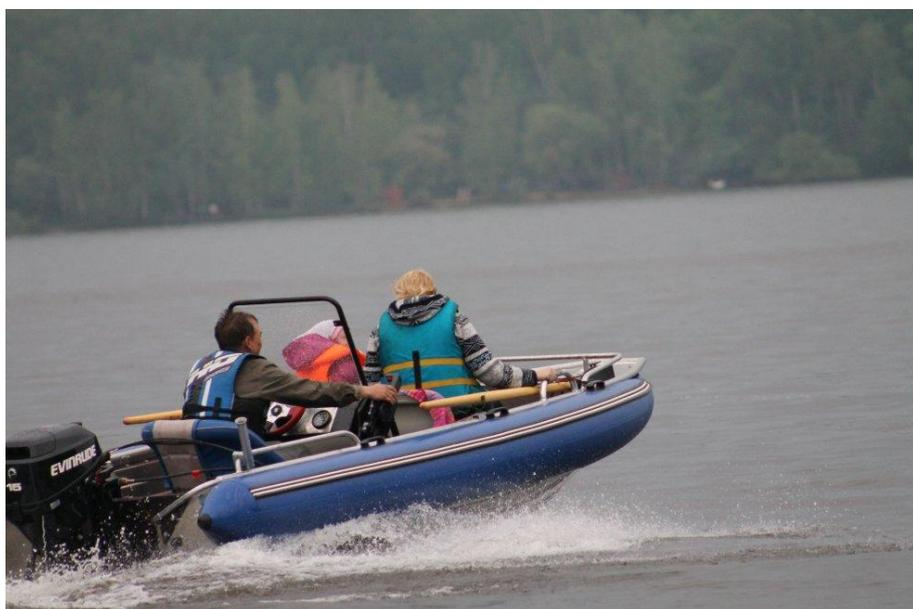
**Надувные быстросъемные борта (баллоны)** решают проблему устойчивости и ходкости любой лодки. При использовании **надувных бортов (баллонов)** грузоподъемность лодки увеличивается более, чем на 150 кг. Повышается устойчивость алюминиевой или деревянной лодки – вы сможете перемещаться и стоять на краю лодки с **надувными бортами** без опасения перевернуться.
