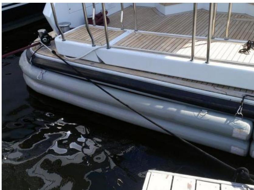
**Надувной кранец** предназначен для защиты бортов лодок (судна) от удара о борт другой лодки или о причальную стенку во время швартовки. **Кранец** выполнен из высокопрочного ПВХ-материала, который устойчив к ультрафиолетовым лучам.
