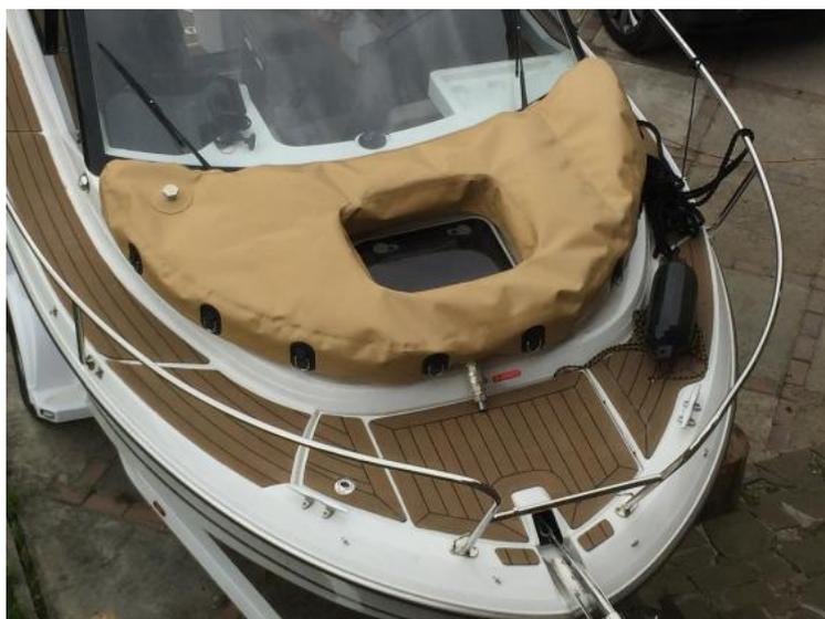
**Мягкая емкость для топлива на яхту и катер** представляют собой портативную, мобильную, сверхпрочную емкость для топлива на Ваше судно. Она предназначена для хранения, транспортировки и использования различных **видов топлива**.
