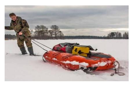
**Надувные санки для охоты и рыбалки** по конструкции аналогичны **санкам «Тобогган»**, имеют прямые опорные баллоны с приклеенными к ним гибкими полозьями. Между опорными баллонами находится небольшая палуба.
