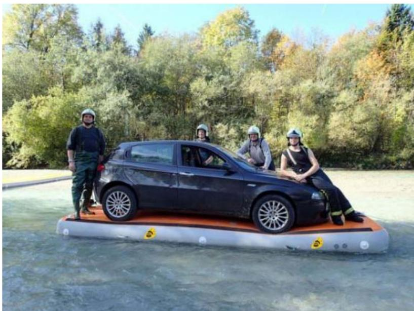
**Плавающая платформа** предназначена для спасения и поиска людей, объектов, транспортных средств и животных. **Надувная платформа** оснащена дополнительными **ремнями безопасности** для надежной фиксации техники во время транспортировки.
