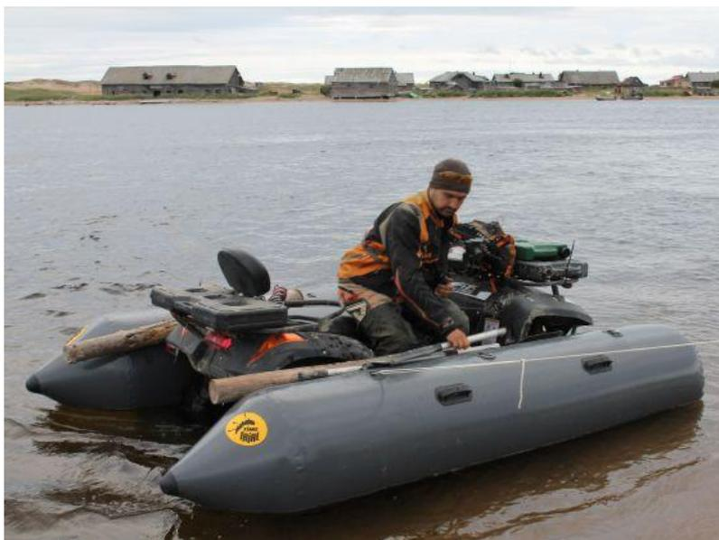
**Квадроцикл** заезжает на надувной плот и зажимается между надувными баллонами из ПВХ под действием собственного веса. Наклеена дополнительная ткань ПВХ. Грузоподъемность **квадроплота** около 700 кг.
