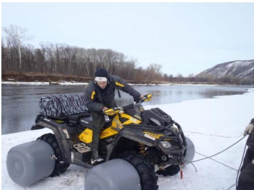
**Надувные поплавки** заменяют плот для квадроцикла, автомобиля и позволяют передвигаться на воде за счет вращения колес. Очень удобный, комфортный, а главное, быстрый способ переправы через водоем на квадроцикле. Для экспедиций и дальних походов незаменимая и очень удобная вещь.
