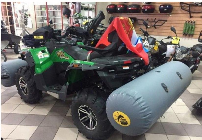
**Квадробаллоны** служат для преодоления водных преград на квадроцикле. **Квадробаллоны из ПВХ** заменяют плот для квадроцикла и позволяют передвигаться на воде за счет вращения колес. Квадробаллоны спереди привязываются за кенгурятник, сзади на растяжки от нижних рычагов к верхнему багажнику.
