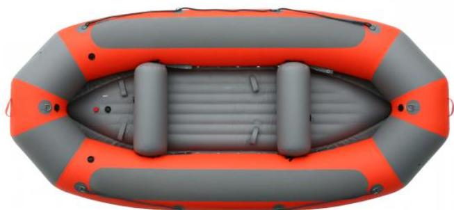
**Рафт** изготовлен из высокопрочной синтетической ткани с двусторонним ПВХ покрытием. **Дно на баллонах** усилено вторым ненапряжённым слоем материала. Надувное дно имеет перепускной клапан для предохранения от избыточного давления.
