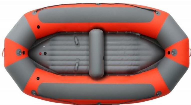
**Рафт** изготовлен из высокопрочной синтетической ткани с двусторонним ПВХ покрытием. **Дно на баллонах** усилено вторым ненапряжённым слоем материала. **Надувное дно** имеет перепускной клапан для предохранения от избыточного давления.
