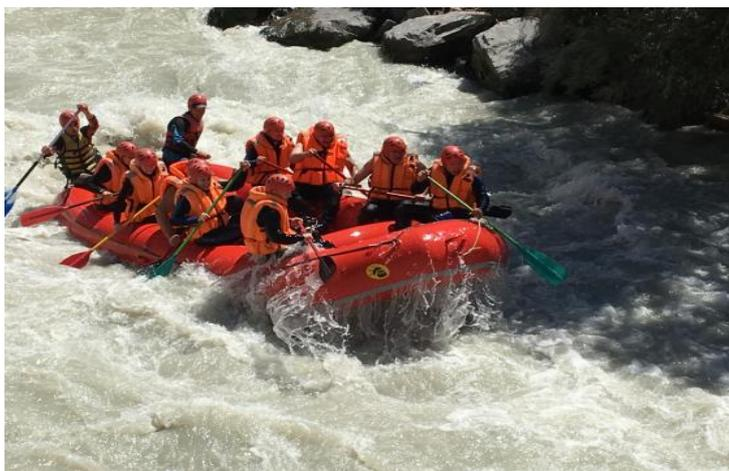
**Надувной Рафт 20f** для сплава по рекам изготовлен из высокопрочной синтетической ткани с двусторонним ПВХ покрытием. Дно на баллонах усилено вторым ненапряжённым слоем материала. Надувное дно имеет перепускной клапан для предохранения от избыточного давления.
