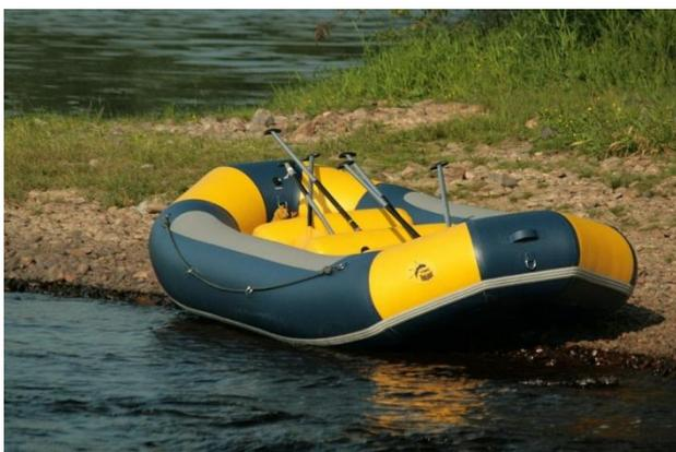
**Рафт** изготовлен из высокопрочной синтетической ткани с двусторонним **ПВХ покрытием**. Дно на **баллонах** усилено вторым ненапряжённым слоем материала. Надувное дно имеет перепускной клапан для предохранения от избыточного давления.
